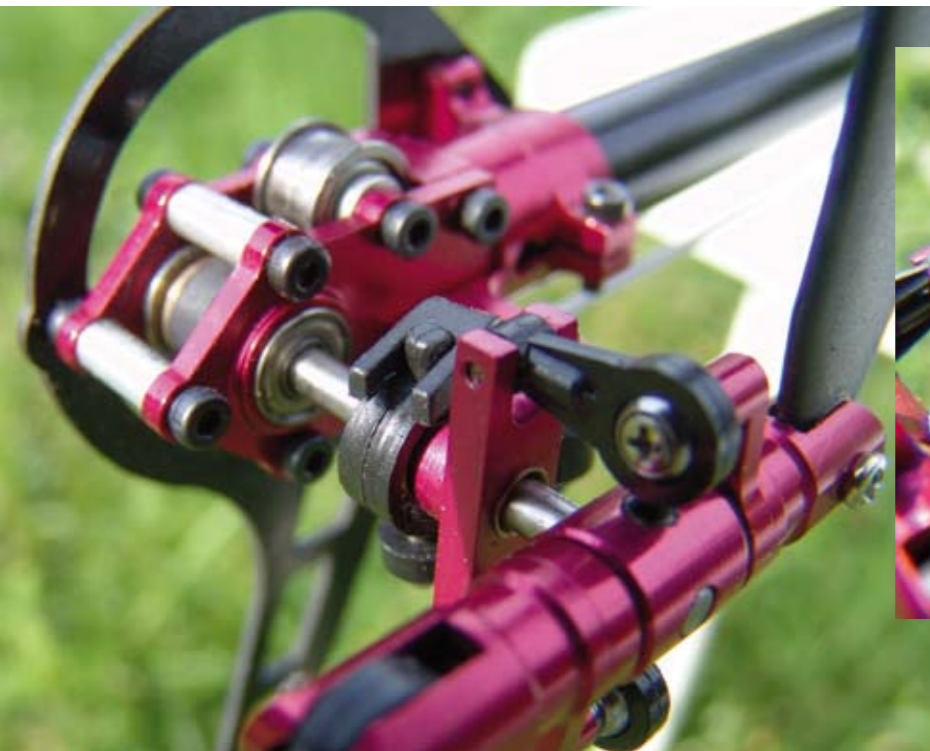
Der spielarme Heckrotor mit seiner Pitchbrücken-Doppelanlenkung. Der Antrieb erfolgt über Zahnriemen, wobei eine Andruckrolle ein Überspringen bei starker Belastung verhindert
