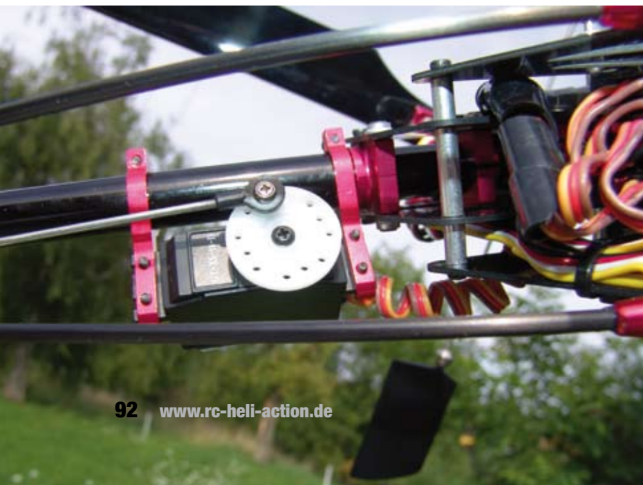
Blick von unten auf das am Heckrohr angeflanschte Servo (Speed-Version), das in Verbindung mit dem Gyro für gute Heck-Performance sorgt
