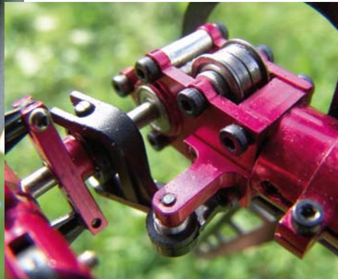
Der spielarme Heckrotor mit seiner Pitchbrücken-Doppelanlenkung. Der Antrieb erfolgt über Zahnriemen, wobei eine Andruckrolle ein Überspringen bei starker Belastung verhindert
