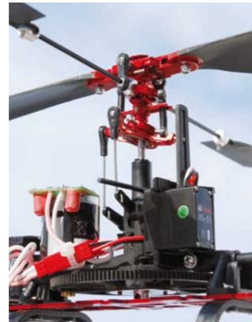
Taumelscheibe und Rotorkopf sind dank Aluminium-Bauweise präzise und robust
